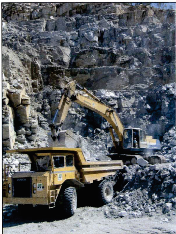
Fot. 1 - Vista de uma frente de desmonte e da operação de carregamento de um dumper
